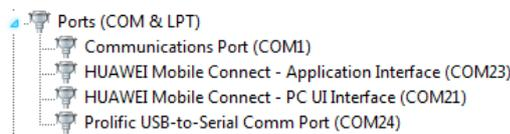
Berdasarkan tampilan device manager di atas terlihat bahwa modem 4G LTE terpasang pada port COM23 sebagai COM Port.
